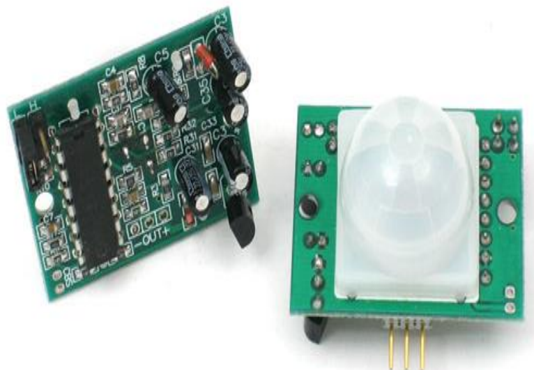
Gambar 3. Bentuk fisik sensor PIR (Components101, 2023)
