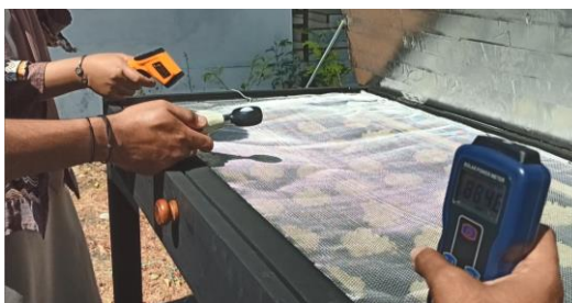
Gambar 4. Uji kinerja alat pengering kompor surya
