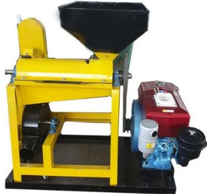
Gambar 4. Salah Satu Alat Praktek yaitu Mesin pencacah kulit kopi
