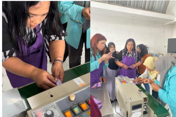
Gambar 3. Proses Penyegelan Kemasan Menggunakan Mesin *Continuous Sealer*
